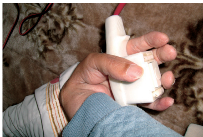
3Dプリンタで製作したパソコン用入力スイッチ
